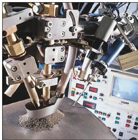
Bei bis zu 100 m Schweißnähten an einem Apparat entscheidend: UP-Schweißautomat sorgt für materialfreundliches Schweißen durch geringe Wärmeeinwirkung
