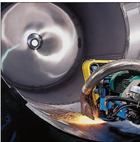
Unser Inside Schleifautomat für Zargen, Böden und Stützen arbeitet vollautomatisch. Perfekt geschliffene Stahloberflächen bilden die ideale Grundlage für die Emaillierung
