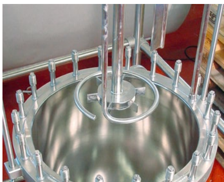
Turbine stirrer with gas inlet sparging tube for hydrogen Turbinenrührer mit Gaseinleitbrause für Wasserstoff
