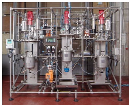
Automation as requested – fully automated multi-reactor system Automation nach Wunsch – komplett automatisierte Multi-Reaktor Anlage
